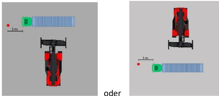
Warteposition (mit rotem Punkt markiert) beim Verladen mit Portalkran: 6 m hinter dem Anhänger des Lastkraftwagens, in einer Linie mit der vom Lagerbereich weiter entfernten Seite des Lastkraftwagens.
